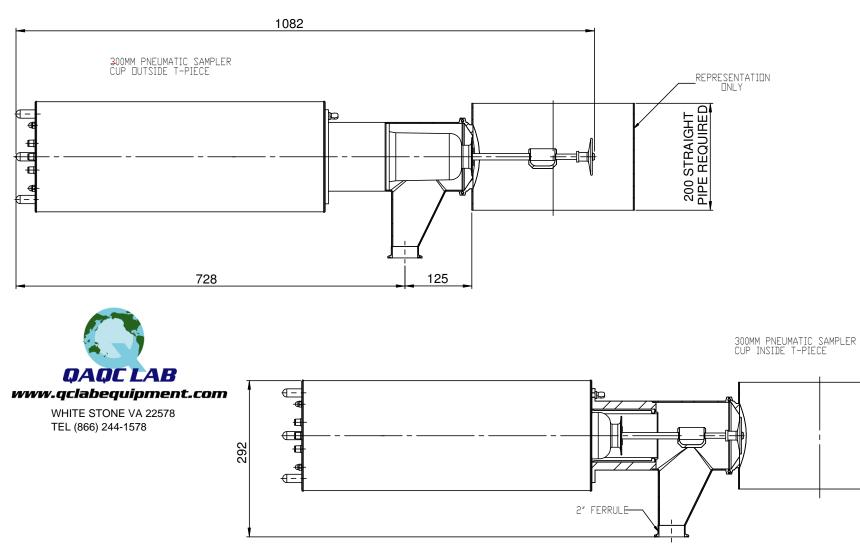
300 MM PNEUMATIC SAMPLER SHOWS 220MM STROKE
